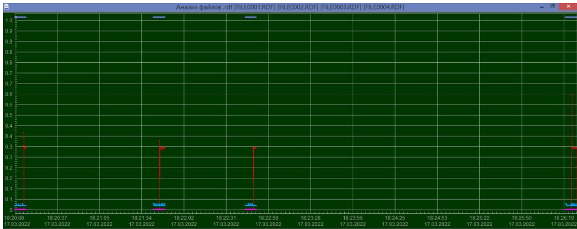
Рисунок 33 – Пусковые токи при ходе раздвижки 217 мм давление 0,1...0,4Мпа
