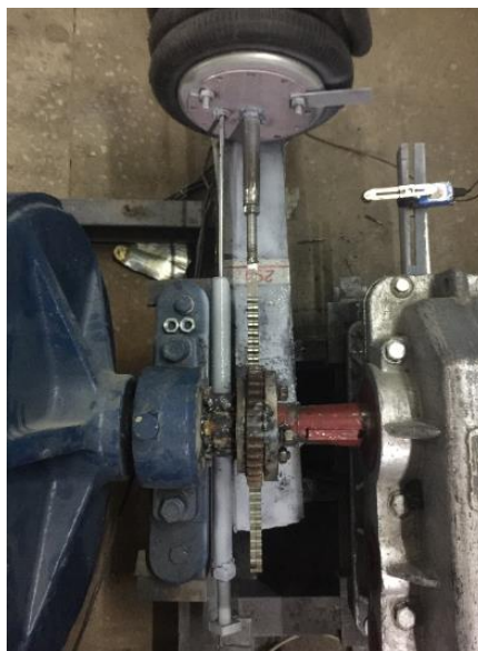
Рисунок 4 – Общий вид пневмоподпора
