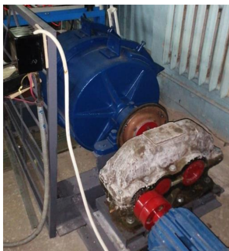
Рисунок 15 – Стенд на базе лабораторной барабанной мельницы
