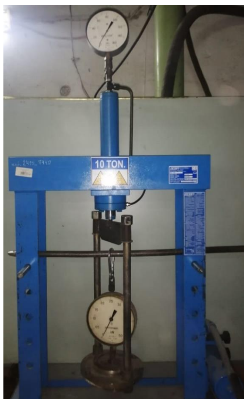
Рисунок 22 – Общий вид пресса с приставкой для его тарировки.
