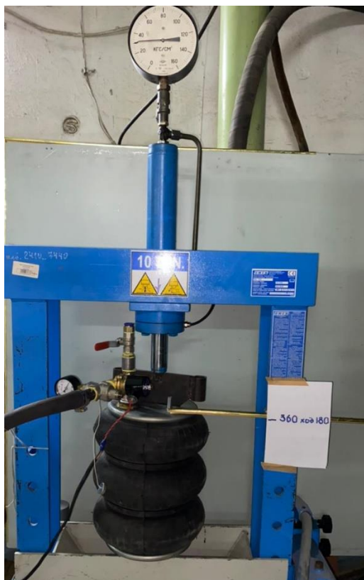
Рисунок 24 – Схема расположения сильфона в рабочей зоне пресса.
