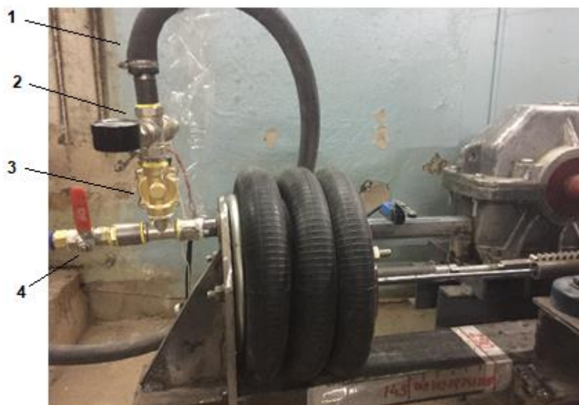
Рисунок 6 – Блок перемещения рейки.
