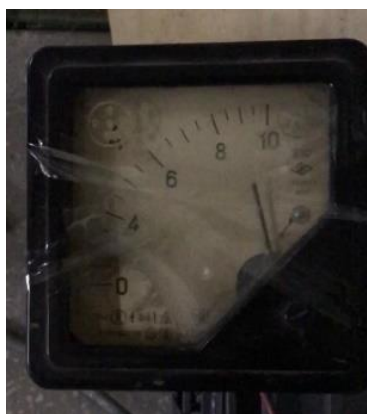
Рисунок 26 – Показания амперметра пуска главного привода без вспомогательного привода
